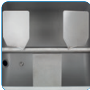
Rührwerk aus Edelstahl.
