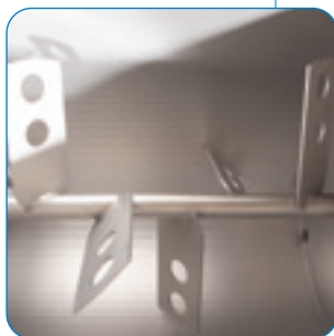
Rührwerk aus Edelstahl.
