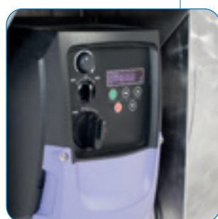
Bedienelement für stufenlose Drehzahl- regelung.
